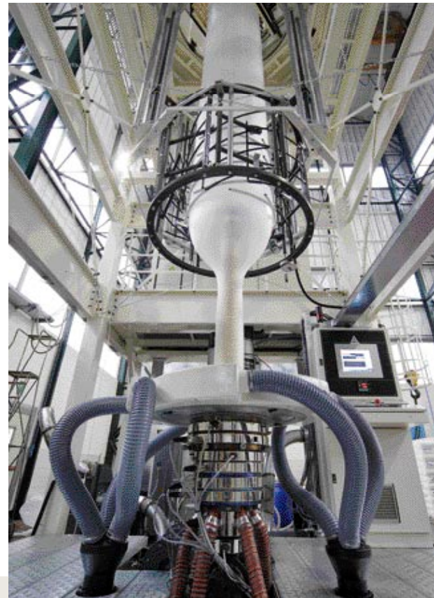
Sopra, da sinistra: linea di estrusione MAM; il dosatore e l'estrusore; un'immagine della testa e della bolla A sinistra, l'avvolgitore
